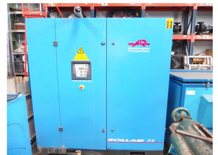
Compresor de tornillo 55 kw.
