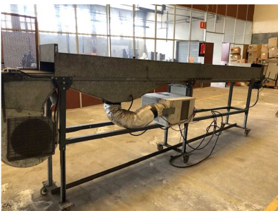
Túnel de secado 4000x400 mm.
