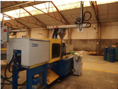
Inyectora termoplástico 90 ton. Robot Tecnomatic MATEU&SOLE METEOR 440-75-90 V2008 Ref: 17571
